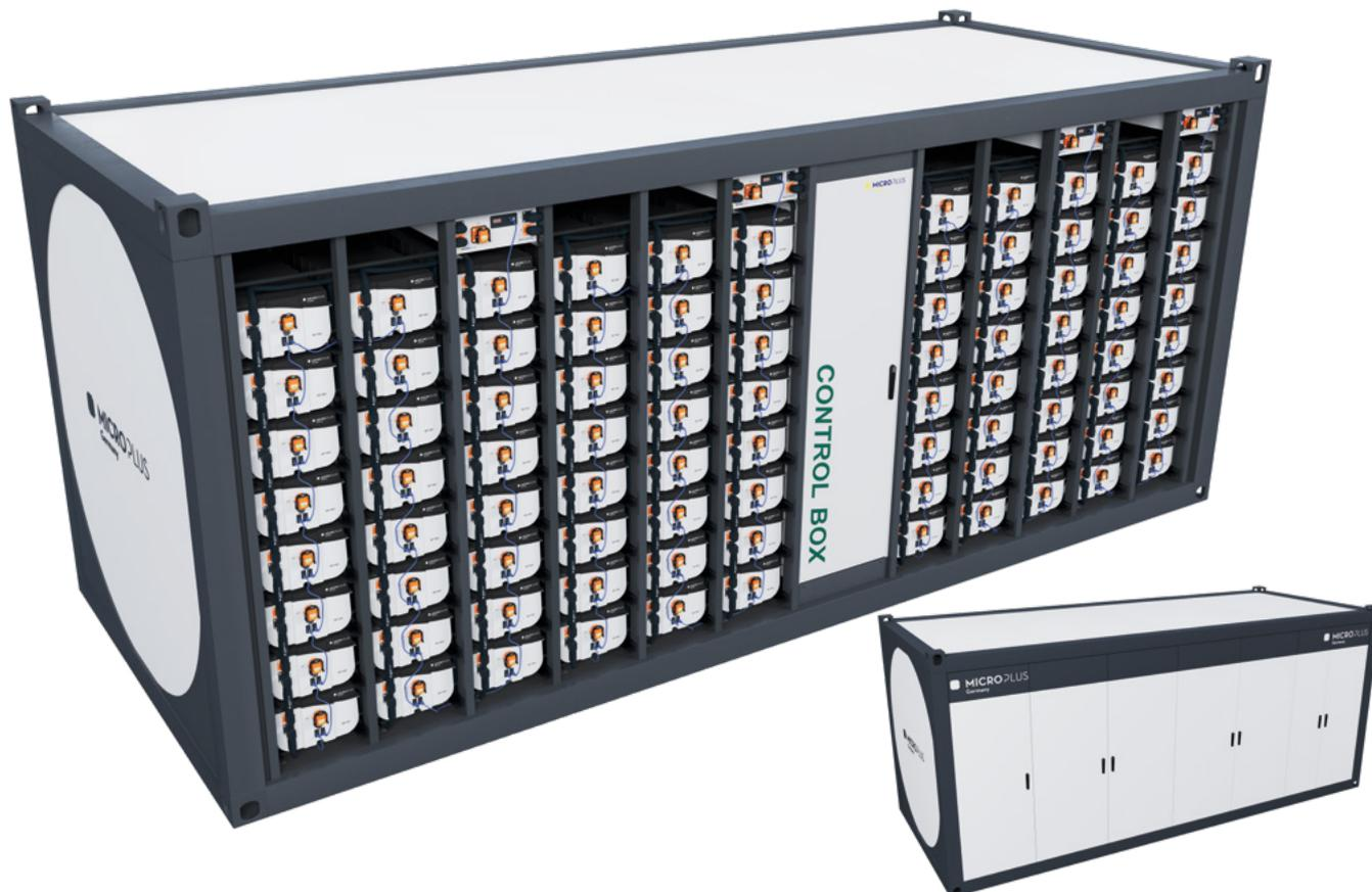
La série **CMT** de conteneurs avec **racks** de **modules MP-MH/51,2-0314** est idéale pour les applications à forte demande énergétique avec des tensions et puissances moyennes. Ces conteneurs sont configurés avec des **racks** de 8 **modules** en série, ce qui permet d'ajuster la tension dans une plage de 358 à 461 V et d'atteindre une capacité de 128,7 kWh. Les **racks** sont combinés en parallèle pour fournir la puissance requise, offrant des capacités allant de 0,5 MWh à 1,5 MWh.
