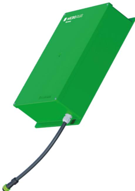
Nos réverbères stockent l'énergie dans des batteries lithium-fer-phosphate (([pag. 166](#)) avec des cellules 32.700 de 8 000 cycles, fournies avec une boîte ABS, des connecteurs IP68 et un BMS pour une charge équilibrée.
