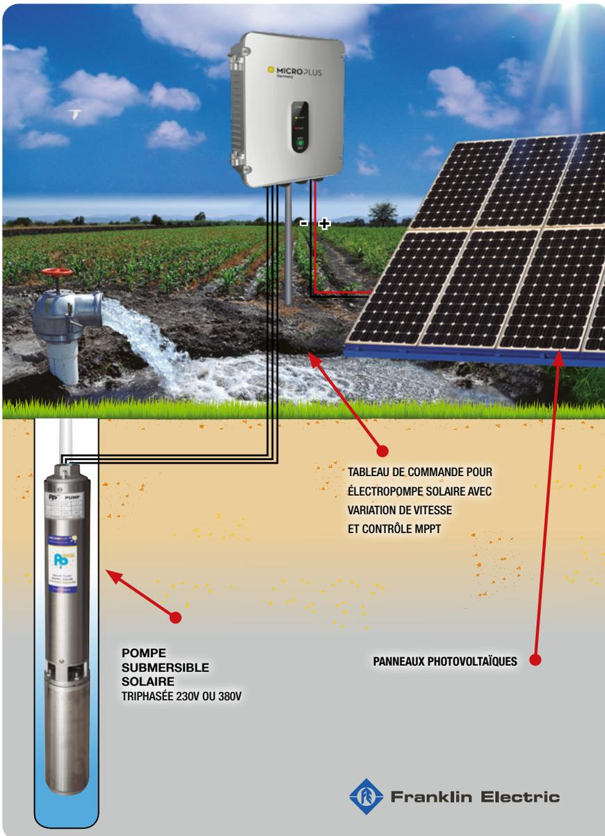
Kit conçu pour l'extraction d'eau à partir de l'énergie solaire.
